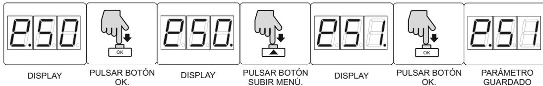
Volver al parámetro e.5 para iniciar la memorización de la posición de inicio de la inhibición de la fotocélula al abrir:
